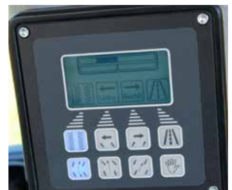
Monitor za upravljanje krmiljenja koles
