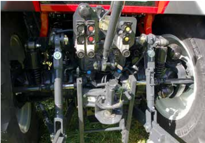
Hidravlične roke za krmiljenje zadnjih koles, ki omogočajo zamik zadnjih koles do 20°
