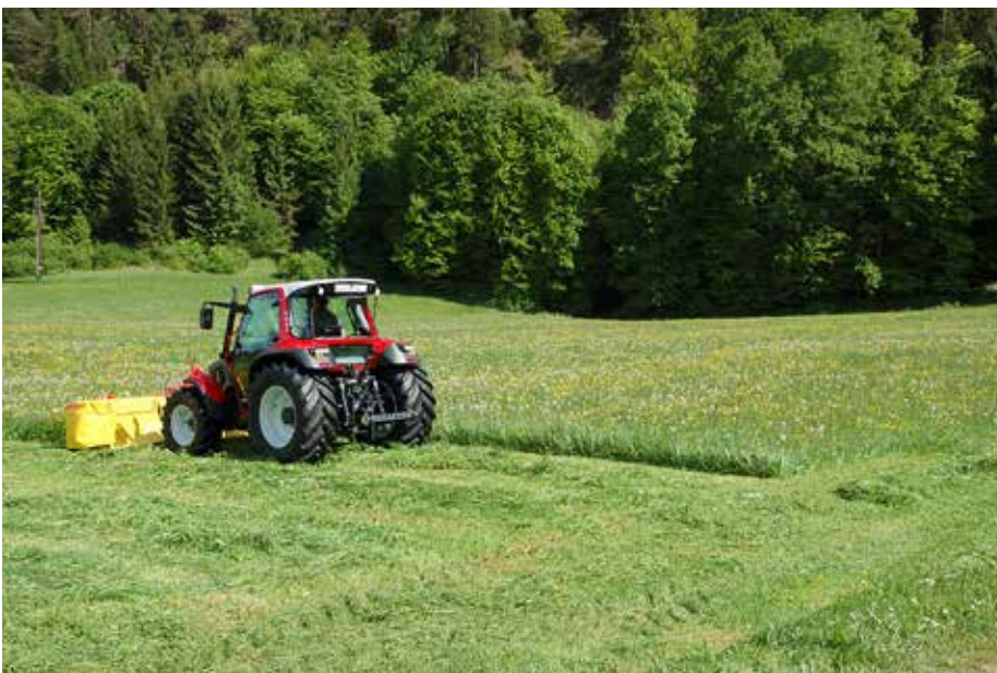
Krmiljenje vseh koles omogoča obračanje na robu parcele brez nepotrebno velikega manevrirnega prostora. V primerjavi s standardnim traktorjem enake velikosti je premer obračalnega kroga za približno 2 m manjši.
